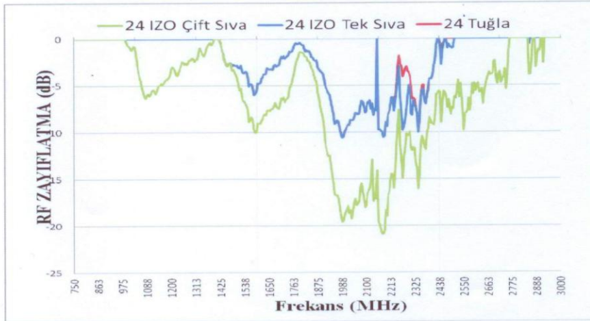
24 x 24 x 23,5 cm. İzotuğla, sıvasız, tek taraflı sıvalı ve çift taraflı sıvalı durumda RF zayıflama eğrisi karşılaştırması
