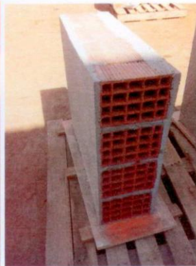
19 x 19 x 13,5 cm. Yatay Delikli Tuğla (Çift tarafı sıvalı)
