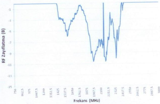
24 x 24 x 23,5 cm. İzotuğla Yatay Polarizasyon
